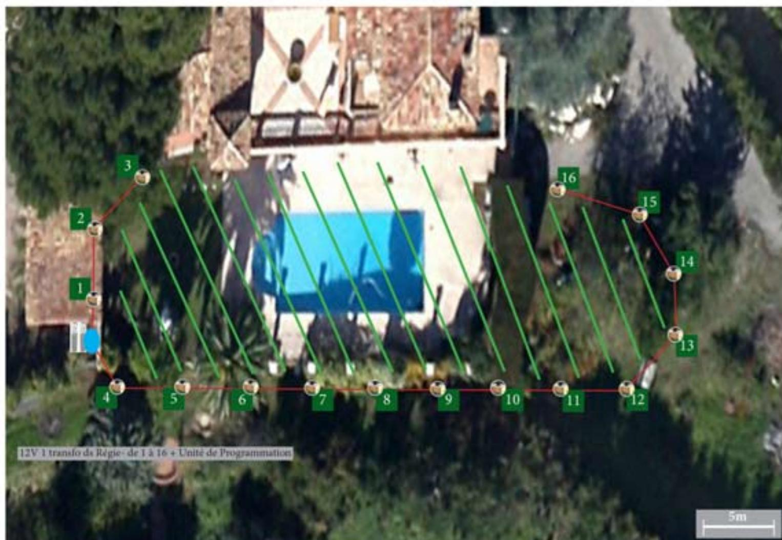
L'ensemble des Modules-Pièges sont disposés dans et contre les massifs de végétation, la gaine de 25 mm, de couleur noir, circule dans les végétaux, en apparent. Au départ de la Régie, la gaine de 25 mm, part en deux réseaux ;
